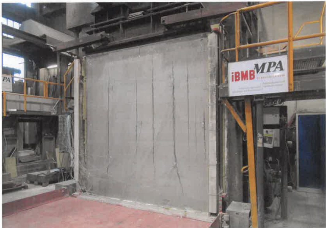
175. Minute: Wasserdampfaustritt an weiteren Rissen sichtbar (FA).
