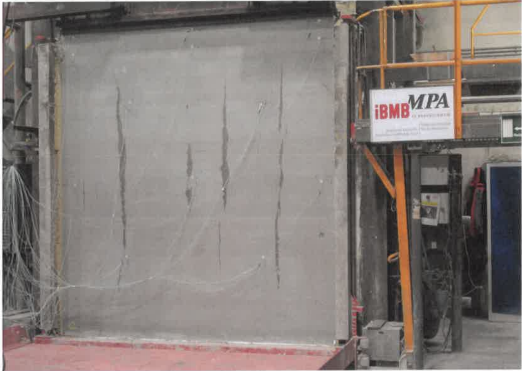
90. Minute: Weiteres Kondenswasser tritt an den Rissen aus (FA).
