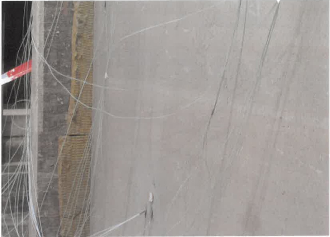
21. Minute: Weiterer vertikaler Haarriss zwischen den Messstellen 2 und 4 (FA).
