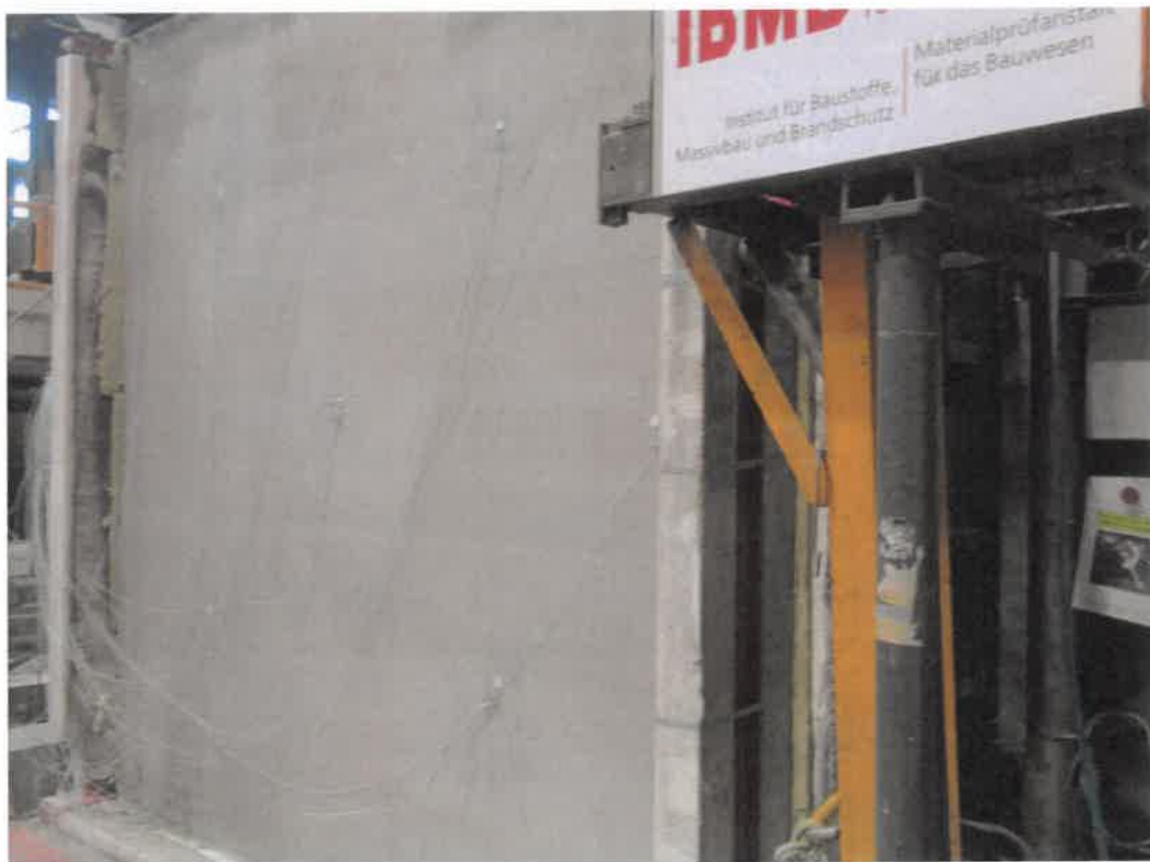
1. Minute: Keine Rissbildung nach der Belastung sichtbar (FA).
