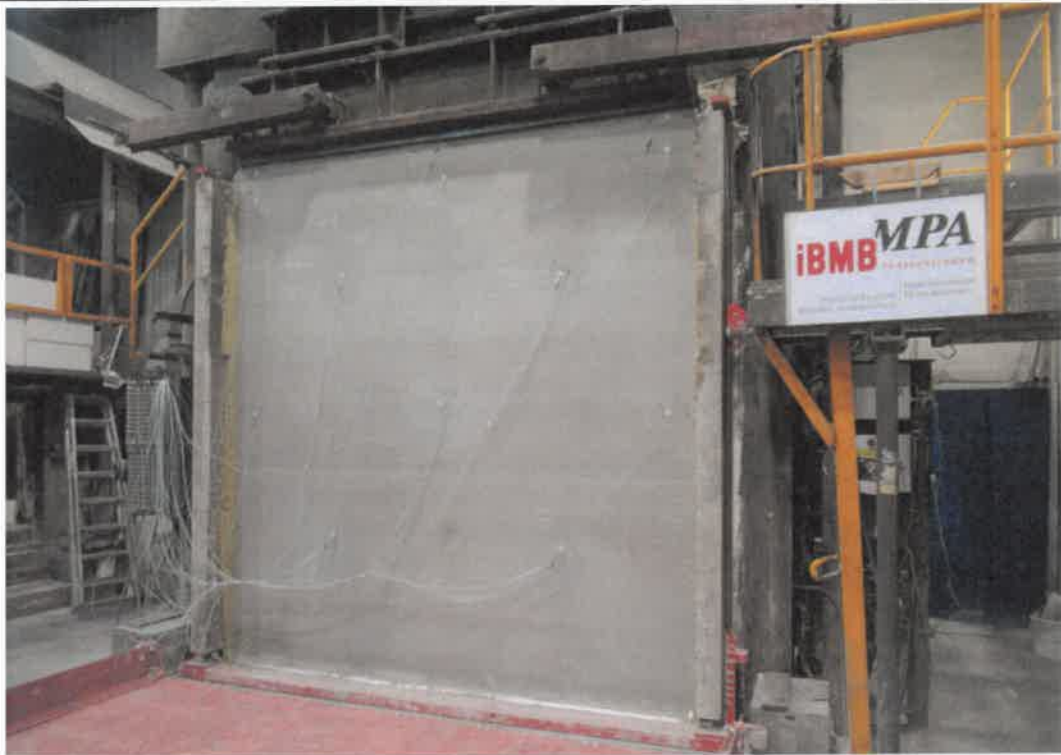
Probekörper im eingebauten Zustand (FA = Feuerabgewandte Seite).
