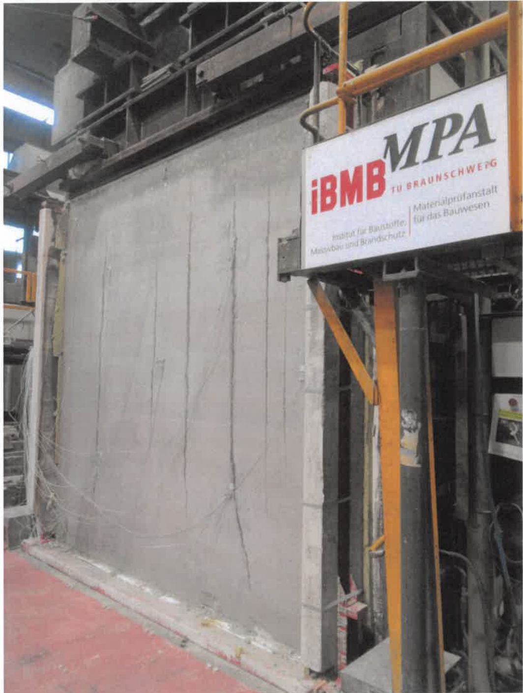
181. Minute: Keine Risse infolge der ersten zwei Stoßbeanspruchungen sichtbar (FA).
